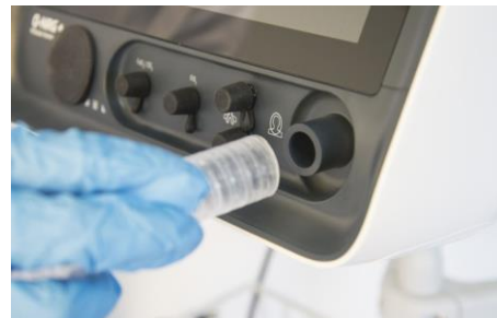
Testy s kanopy vyžadují jednoduché uspořádání s připojením hadice od kanopy k diluční pumpě.
