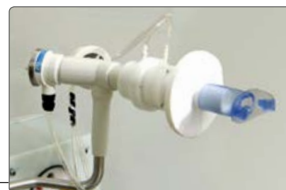
Nová konstrukce dechového ventilu umožňuje snadnou dezinfekci a výměnu pro každého pacienta
